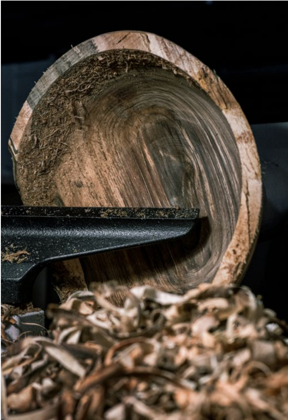
links TANZ DER SPÄNE // JONAS RUATTI Entstehung einer Nussholzschale beim Drechseln, Lienen, 2024
